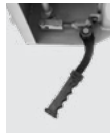
Sicheres Türöffnungssystem an der Seite des Aufliegers.
