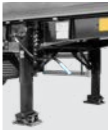
Die zuverlässigen Stütz- beine sind in verschiede- nen Varianten erhältlich: - einzeln aus Stahl, - doppelt aus Stahl oder Aluminium, - doppelt aus Stahl mit stufenloser Höhenver- stellung.
