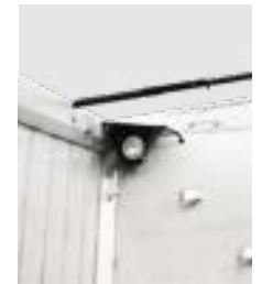
Getreideschieber zum kontrollierten Entladen
