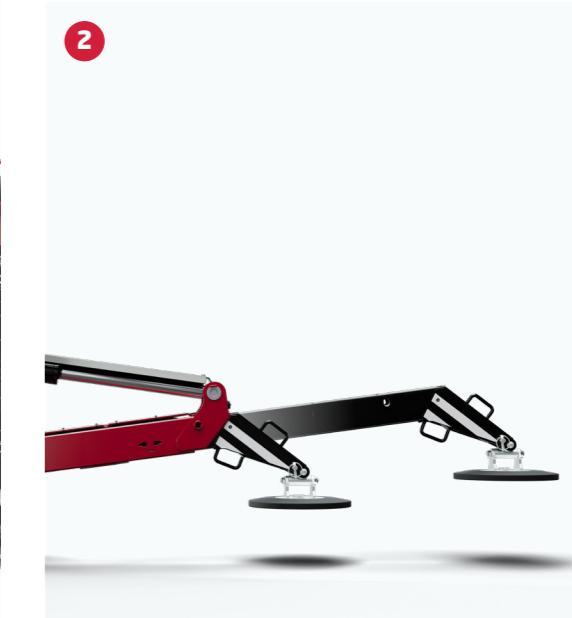
**2 Hydraulisch ausfahrbare Abstützungen**
