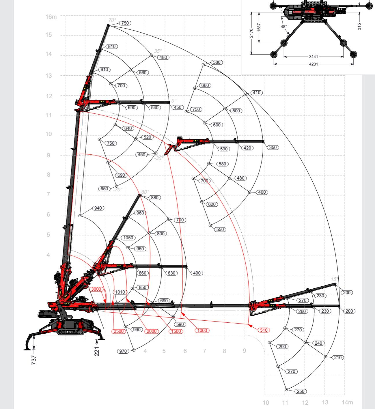
\* Tabelle basierend auf dem Kran mit ausgefahrenem Ballast und ausgefahrenen Stützbeinen.
