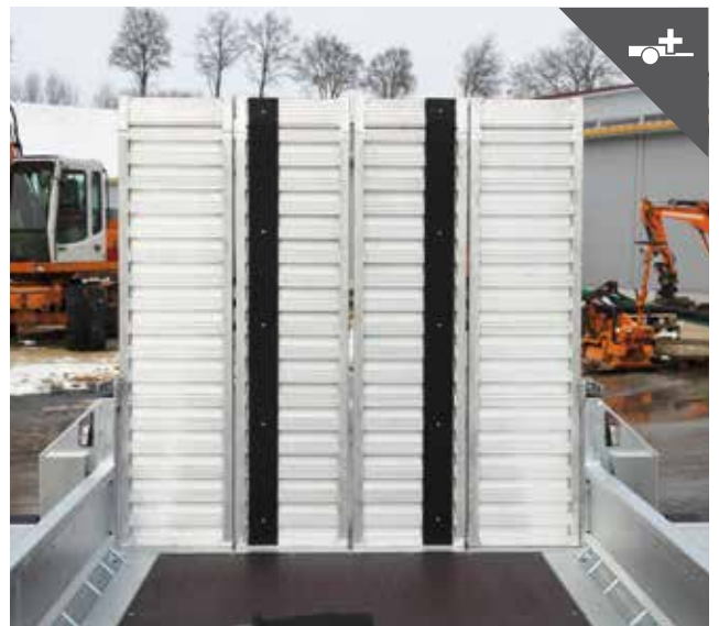
Gummiauflage für das Befahren mit Kettenfahrzeugen
