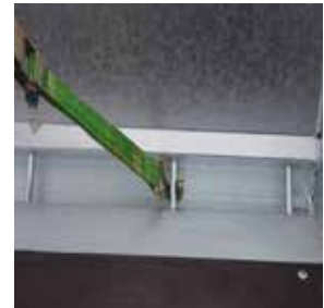
Zurpunkte bis zu 2.000 kg belastbar
