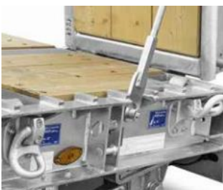
Kletterleisten am Außenrahmen im Bereich der Auffahrtsschräge
