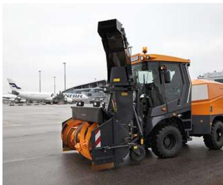
Die Supra 5002 ist eine selbst-fahrende Schneeräummaschine mit wahlweise einer Räumbreite von 2400, 2600 oder 2800 mm.
