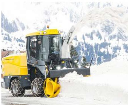
Die Supra 4002 ist eine selbst-fahrende Schneeräummaschine mit wahlweise einer Räumbreite von 2400, 2600 oder 2800 mm.
